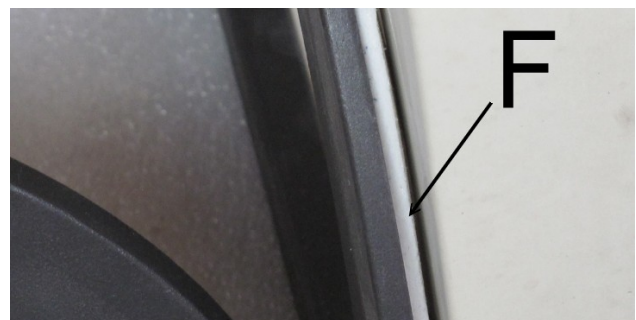
ilustr.15: Feutre en fibres céramiques
